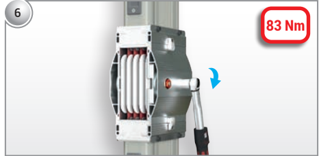
Hizalamaların kontrolü sağlandıktan sonra blok ek somunları 83 Nm ile torqlanır.
